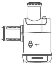
4.插上电源线,开关往上推即可工作,往下推停止工作
